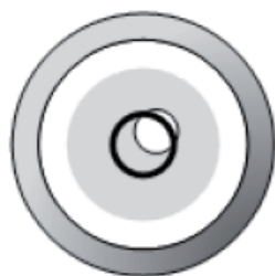
Рисунок 1 — Контроль наклона основания с помощью пузырькового уровня
